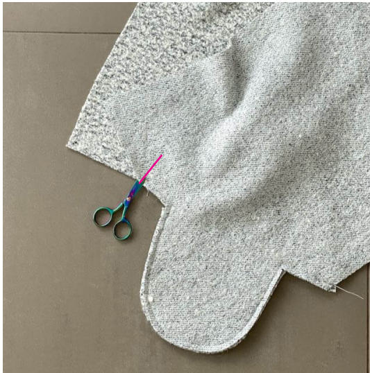
13. An der pinken Linie die Nahtzugabe bis knapp vor die Naht einschneiden.
