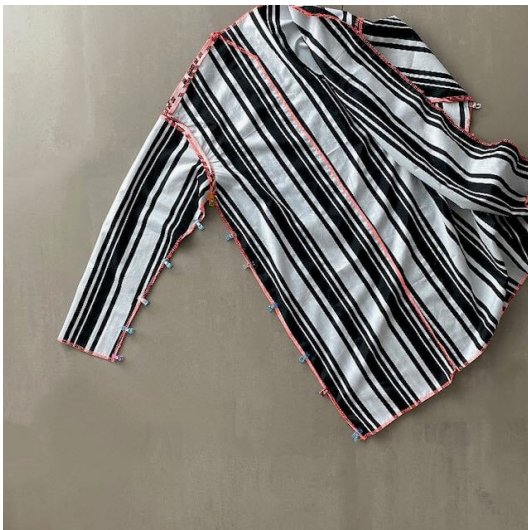
43. Nun wird die Seitennaht gesteckt und genäht.
