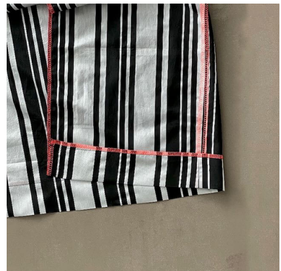
44. Bügelle als nächstes den Saum des Futters. (6 cm Saumbreite, inkl. Nahtzugabe) Nähe ihn mit einem Geradstich um, Stichlänge 2,5.
